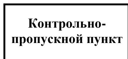
Вывески размещаются на стене здания, на видном месте у главного входа. Надпись на вывесках производится без наклона, прямым шрифтом, на бронзовом фоне черной краской. Размеры вывески: ширина – 600 мм, высота – 400 мм, высота букв и цифр основной надписи – 100 мм, других надписей – до 50 мм.
